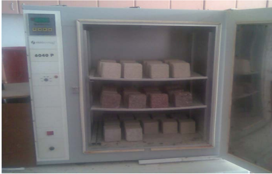
Şekil 2.4. Numunelerin sabit kütleye gelinceye kadar etüvde bekletilme işleminin gerçekleştirilmesi
