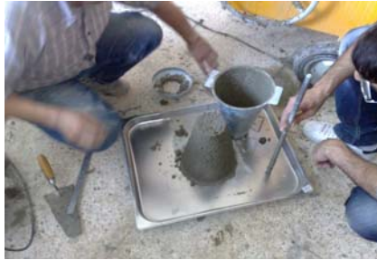
Resim 3. Kolemanit katkılı hafif beton işlem örnekleri (Slump- Kalıplama)
