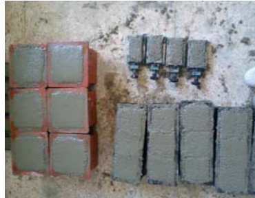
Resim 3. Kolemanit katkılı hafif beton işlem örnekleri (Slump- Kalıplama)
