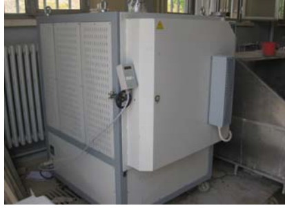
Resim 2. Protherm HLF 150 marka laboratuvar tipi fırın ve ultrases hızı ölçüm cihazı
