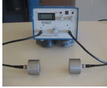
Resim 2. Protherm HLF 150 marka laboratuvar tipi fırın ve ultrases hızı ölçüm cihazı
