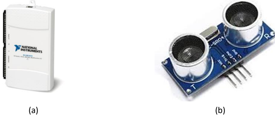
Şekil 1. a) NI USB-6210 veri toplama kartı b) HC-SR04 ultrasonik mesafe sensörü
