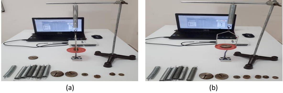
Şekil 6. a) Yay 1 deney düzeni b) Yay 2 deney düzeni
