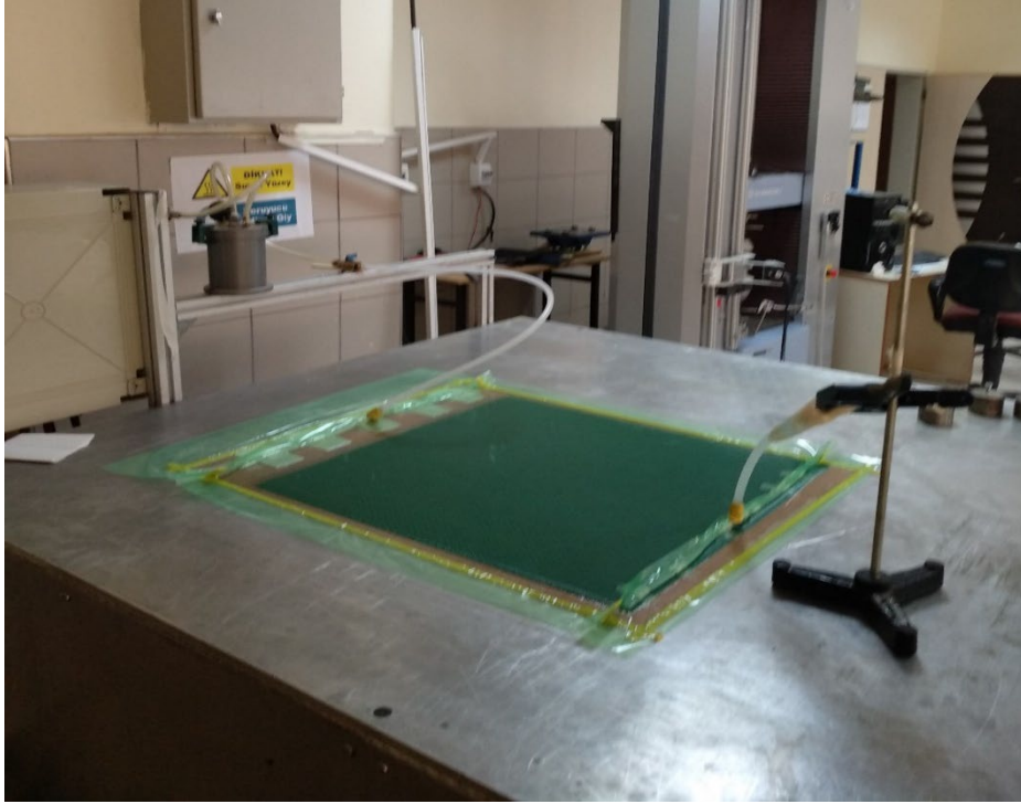
Şekil 1. Nanokompozit katkılı CTP kompozit plakanın VDRİT yöntemi ile üretilmesi.
