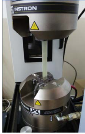
Şekil 2. Kompozitin elastisite modülünün belirlenmesi
