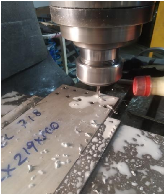
Şekil 3. Inconel 718 alaşımlı malzemeye ön delik delme işlemi
