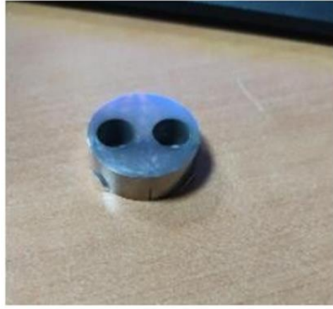
Şekil 7. Ti-6Al-4V malzemeye tel erozyonda delik delme
