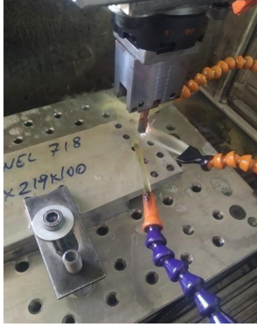
Şekil 4. Inconel 718 alaşımlı malzemenin dalma erozyon ile delik delme işlemi
