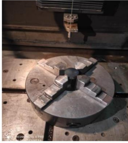
Şekil 6. Ti-6Al-4V malzemeye ön delik delme
