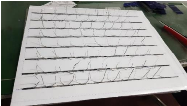
Şekil 6. Panel laminasyonu sonrası panelin arka yüzeyi
