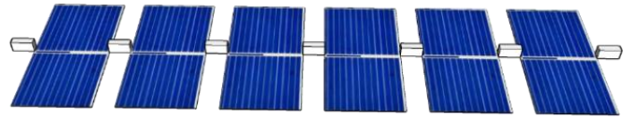
Şekil 8. Altılı seri hücre bağlantı şekli
