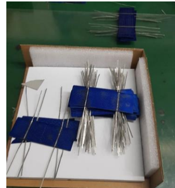
Şekil 1. Ribon bağlantıları yapılmış hücreler
