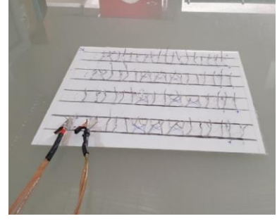
Şekil 7. Test için flash test cihazına panel bağlantısının yapılması
