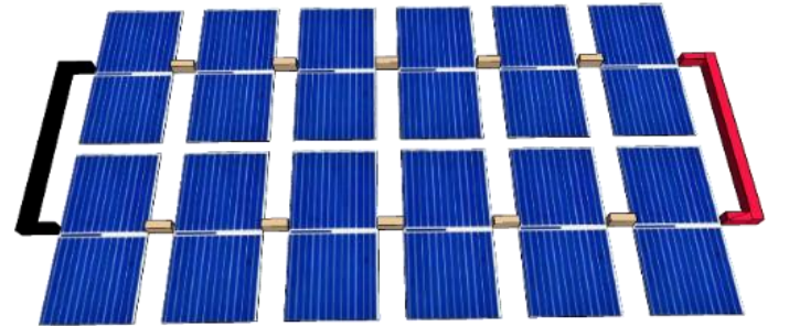
Şekil 9. Birbirine paralel iki adet altılı seri hücreler
