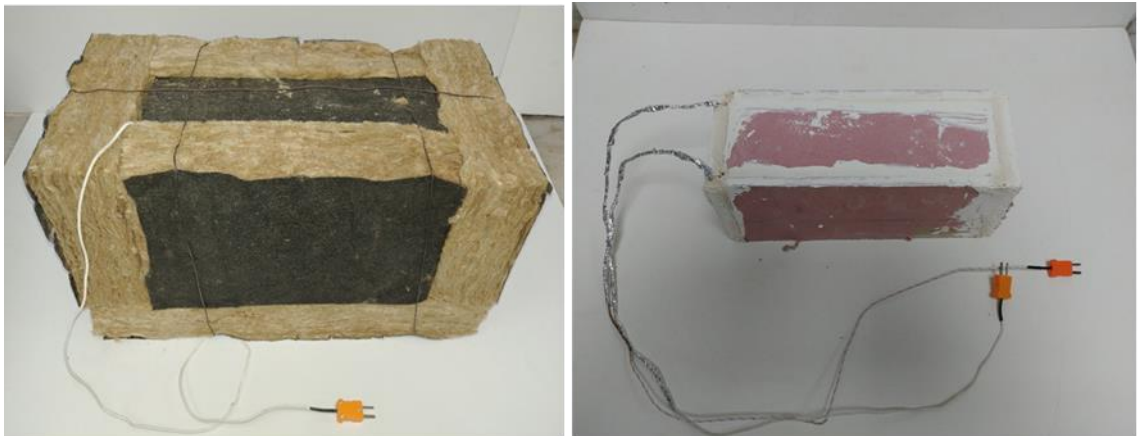
Şekil 2. Yangın yalıtımlı betonarme elemanlar
