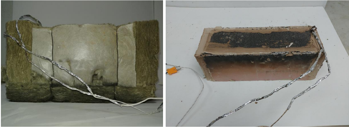
Şekil 7. Yüksek sıcaklık sonrası yalıtım malzemeleri
