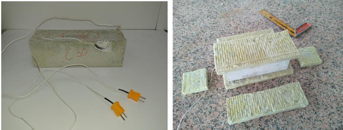
Şekil 1. Betonarme numuneleri yalıtım malzemesiyle kaplanması
