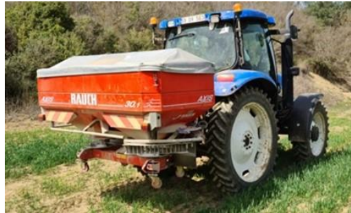
Şekil 7. Çift diskli gübre dağıtma makinası
