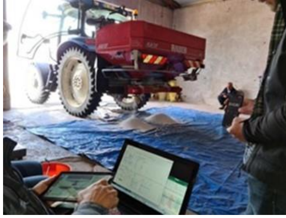
Şekil 9. Değişken oranlı gübre uygulama testleri
