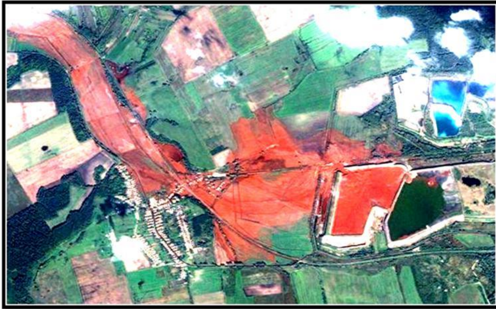
Şekil 7. Macaristan'da baraj yenilmesi sonucu kırmızı çamurun Tuna nehrine yayılışı
