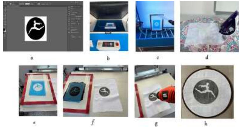
Görsel 5. a: Fosforlu Görünmesini İstedığımız Desenin, Adobe Illustrator Programı Kullanılarak Bilgisayarda Hazırlanması (Pixabay Company, Sergeitokmakov, 2022), b: Üzerine Çıktı Alınan Transparan Filmin, Pozlama Makinesine Şablon İle Beraber Yerleştirilmesi ve Pozlama İşleminin Yapılması, c: Pozlama Sonrası Şablonun Yıkanması ve Baskı Alınacak Nihai Desenin Şablon Üzerinde Oluşturulması, d: Kasnaktan Kumaşın Çıkarılması ve Düzgün Baskı Yapılabilmesi Amacıyla Kumaşın Ütülenmesi, e: Şablonun Emülsiyon Dışında Kalan Kısımının Bantlanması, f: Yerleştirilen Şablona Siyah Baskı Patının Dökülmesi ve Baskı İşleminin Yapılması, g: Baskı Yapılan Kumaşın Kurutulması, h: Baskısı Alınan Kumaşın Kasnağa Gerilmesi ve Aydınlık Ortamda Kumaşın Gösterimi
