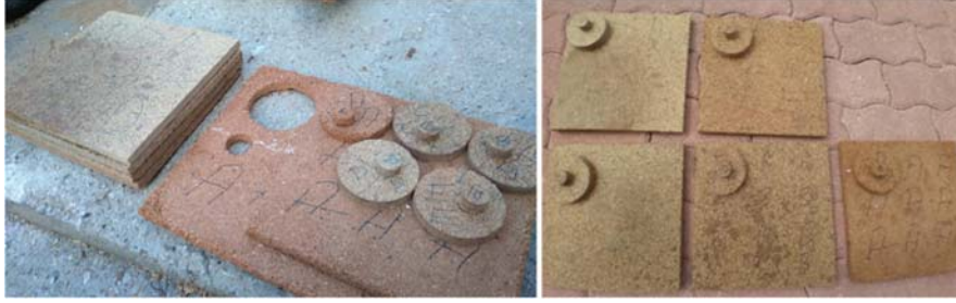
Şekil 7. Badem kabuğu içeren yonga levhaların numune parçaları. Büyük daireler ısı iletkenlik ölçüm testleri içindir. (Sample pieces from particle boards containing almond shells. Large circles are for thermal effective conductivity measurement tests.)
