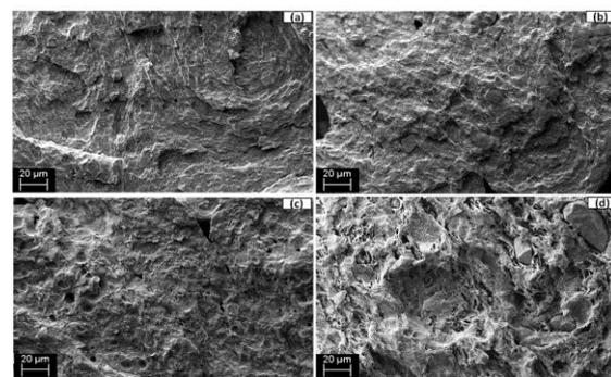
**Figure 2.** SEM images of fracture surfaces (a) PLA, (b) PLA-TPE, (c) PLA-HAp, (d) PLA-HAp-TPE.
