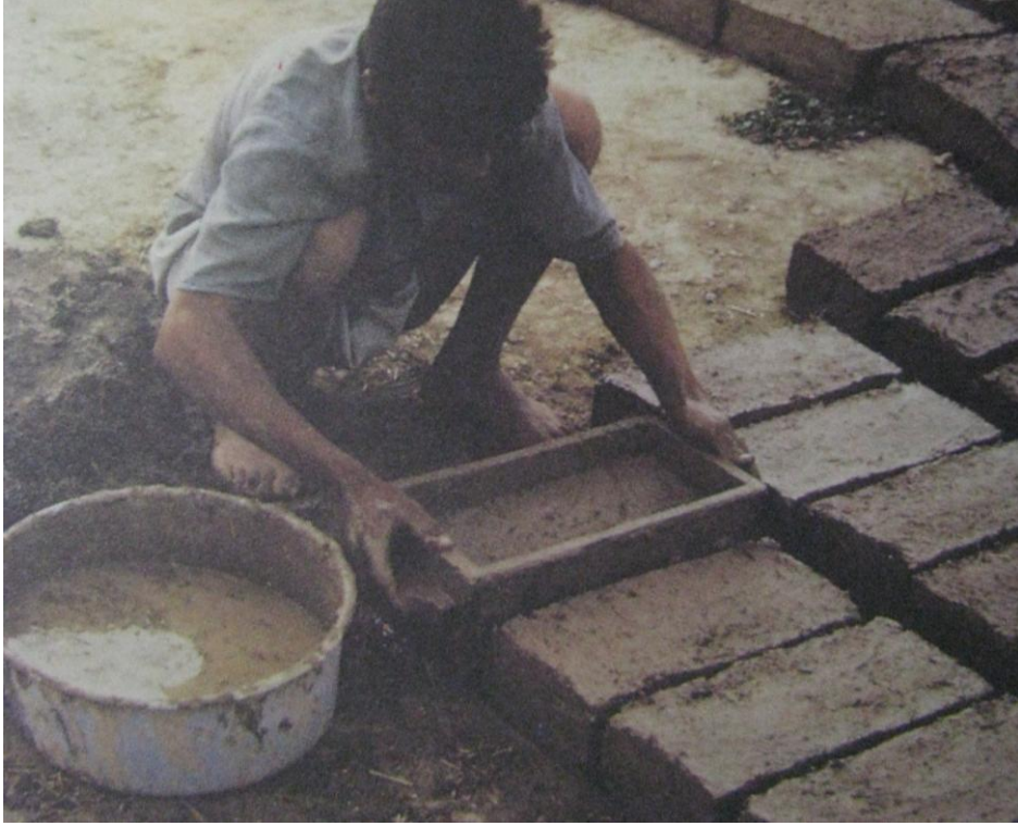
Resim-16 Kalıp yapımı kerpiç. (Roaf, 1996)
