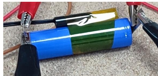
Şekil 8. Termistörün Li-Ion pil yüzeyine bağlantı şekli (Figure 8. Connection of thermistor to Li-Ion battery surface)
