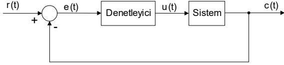
Şekil 1. Geri beslemeli basit bir sistemin blok şeması (Block diagram of a simple feedback system)
