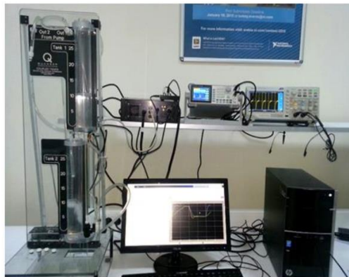
Şekil 1. Deneylerin gerçekleştirildiği Quanser sıvı seviye sistemi
