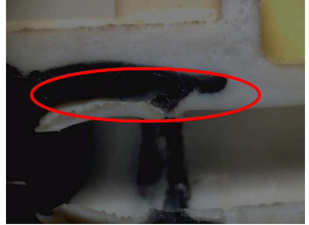
Şekil 15. PA12LX9013 Hatalı Kaynak Mikroskop Resmi
