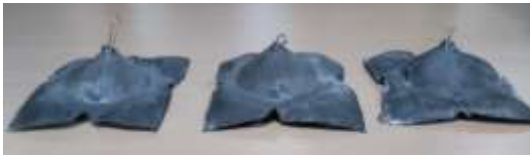
10% Boron carbide filler
