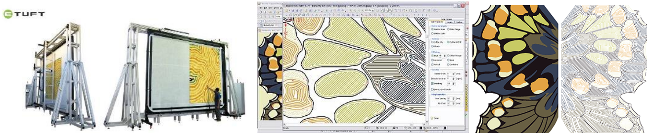
Şekil 8. Tafting tabancası ile çalışılan Hand-tuft halı tezgahı, orijinal Raster (piksel) tasarımı ve tafting için dönüştürülmüş vektörel tasarım [18]
