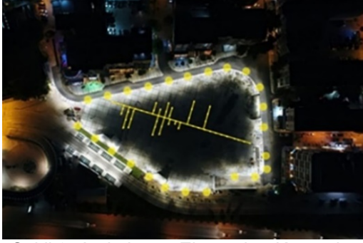
Şekil 9: Aydınlatma Elemanları Konumları Ve Etki Alanları 17
