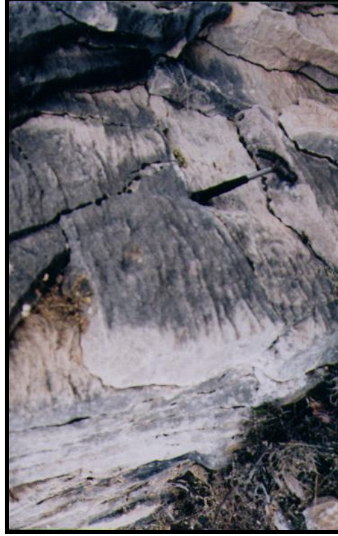
Foto 3. Kumlu kireçtaşı tabakaları birbirini kesen çatlak sistemlerine sahiptir.
