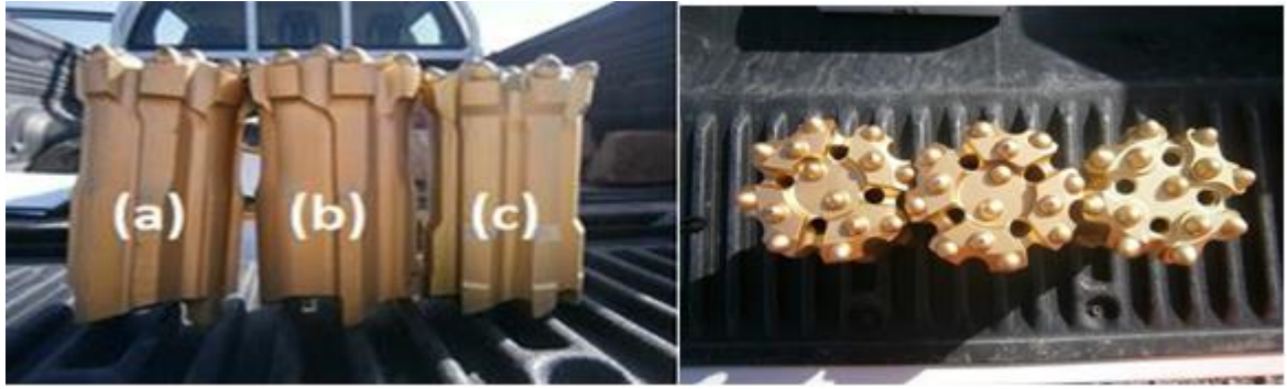
Şekil2.Çalışma kapsamında kullanılan delici uçların başlangıç durumları (a):tipi(Buton), (b):B tipi (Yarı Balistik), (c) : A tipi (Yarı Balistik)
