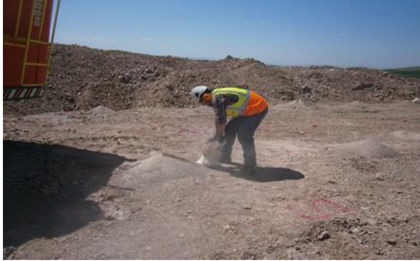
Şekil 5. Delik delme işleminde çıkan kırıntılardan örnek alım işlemi Figure 5. Sampling process from the part removed in the hole drilling process
