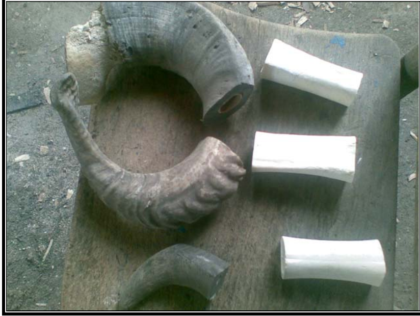
Fotoğraf 2. Bıçak sapı olarak hayvan kemiği ve boynuzları da kullanılmaktadır.
