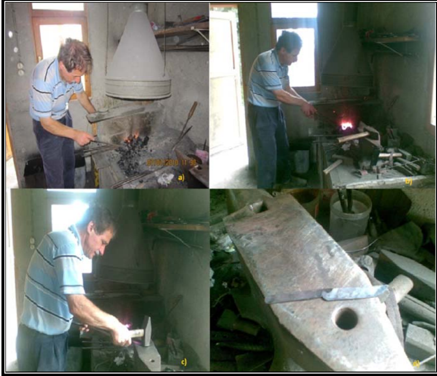
Fotoğraf 3. Geleneksel bıçak imalatında kullanılan çeliğin; a) odun kömürü içinde ısıtılması, b)kor haline getirilmesi, c)örs üzerinde çekiçle dövülerek sertleştirilmesi, d)bıçağın ham hali
