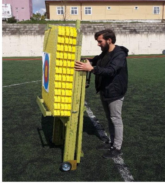
Şekil 8. Ahşap hedef ayağının katlanarak az yer kaplaması
