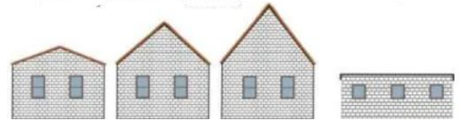
Şekil 2. Farklı eğimlerle farklı iklim bölgeleri için oluşturulmuş çatı örnekleri (Figure2. Examples of roofs created for different climatic zones with different slopes)
