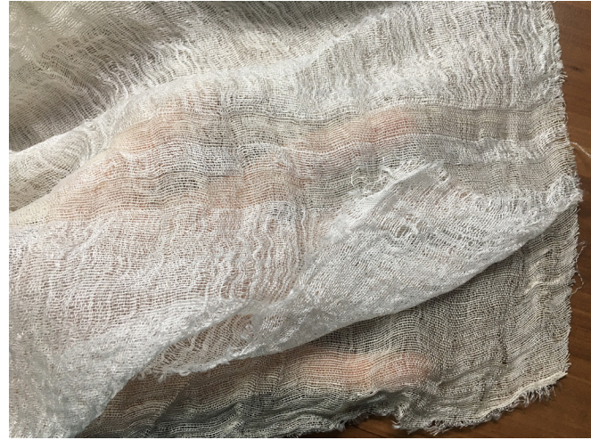
Fotoğraf 10. Bezayağı ve çift kat yapı ile dokunan ipek-keten yarı-şeffaf kumaş, Neslihan Yaşar, 2012.
