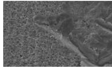
Resim 4: Zirkonyum seramik yüzeyin sol yarısı HIM/SIE yöntemiyle daha tutucu bir yüzey oluşturacak şekilde pürüzlendirilmiştir. Sağ yarısında ise kumlama yöntemiyle
