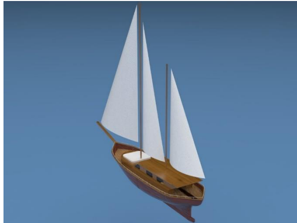
Şekil 8. Yuvarlak kıçlı bir guletin üç boyutlu görünüşü ( L_{OA} = 22.5 m, C_B = 0.298 )
