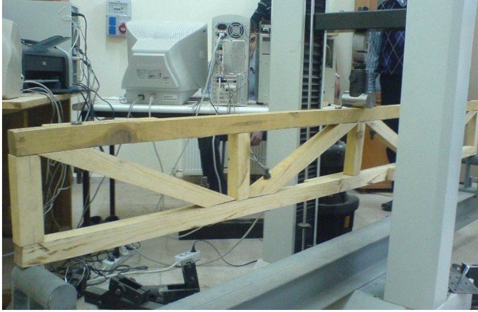
Şekil 2. Laboratuvar şartlarında test edilen kafes kiriş.
