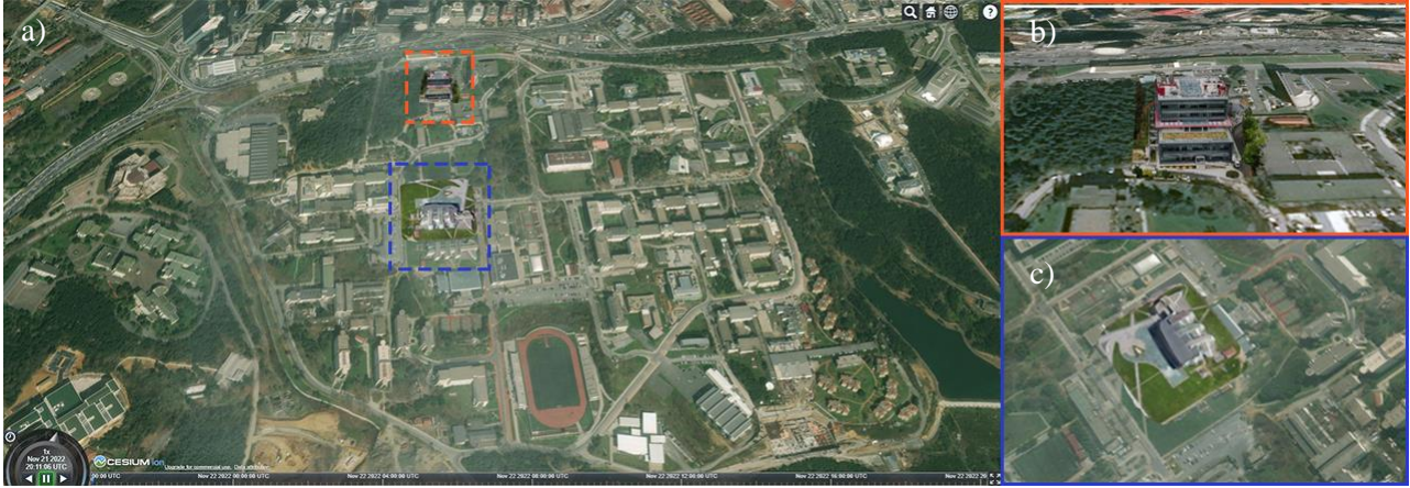
Şekil 9. a) Cesium platformunda, 3B modellerin gerçek konumları ile uydu görüntüsü üzerinde gösterimi, b) İTÜ Lisansüstü Eğitim Enstitüsü ve c) İTÜ Mustafa İnan Kütüphanesi (Cesium, 2022)
