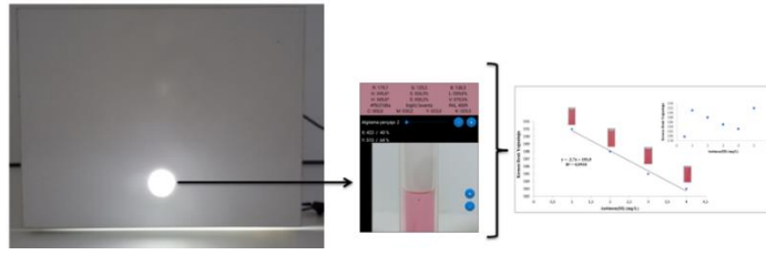
Şekil. Antimon(III) içeren numunelerin dijital görüntüleme yöntemi temelli kolorimetrik analizi /Figure. Digital imaging based colorimetric analysis of samples containing antimony(III)
