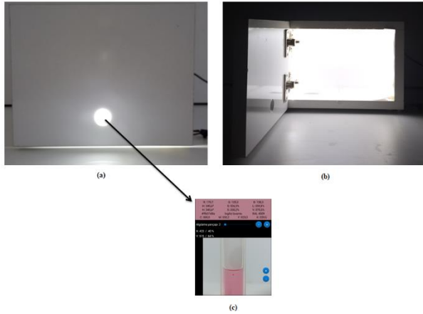
Şekil 1. Dijital görüntüleme kutusu (a) Dış görünüm; (b) İç görünüm; (c) Numune görüntüsü (Digital display box)
