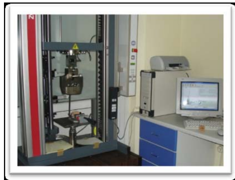
Resim 6. Makaslama testinin uygulandığı düzenek.
