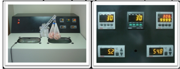
Resim 7. Isısal çevrim işlemi ve cihazın zamanlayıcı, termometre uygulanması ve sayıcı kumandası.
