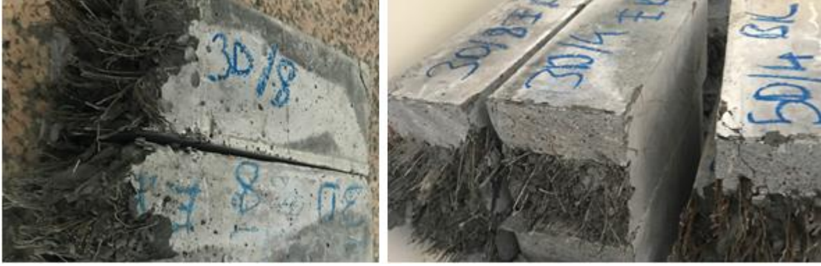
Şekil 5. Çelik lif içeren bazı SIFCON numunelerinin eğilme testi sonrası görüntüleri
