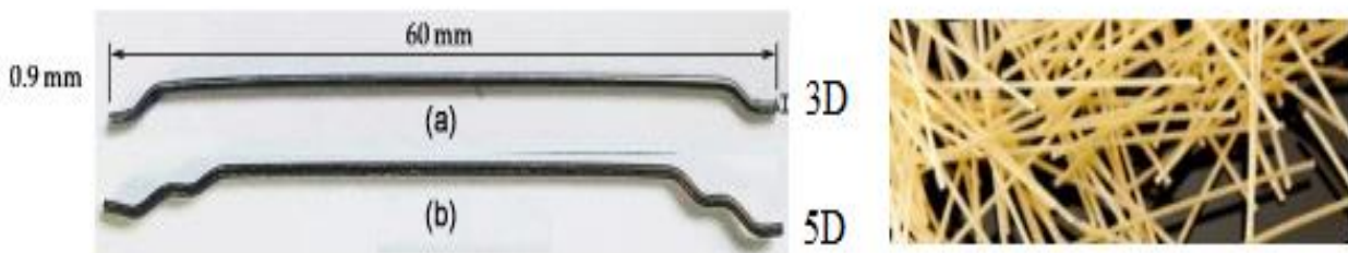
Şekil 1. Normal dayanımlı (3D), yüksek dayanımlı (5D) çelik lifler ve poliolefin lif görüntüsü (Rasheed ve ark., 2018; Lee ve ark., 2021).
