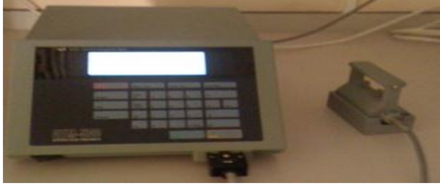
Şekil 2. Isı iletim katsayısı testinin yapıldığı QTM-500 Kyoto cihazı
