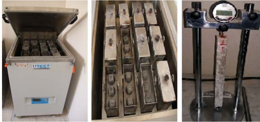
Şekil 2. Alkali silika reaktivitesi tayininin yapıldığı test kabini, içerisine yerleştirilen harç çubukları ve deney sonrası hazırlanan harç çubuklarının komperatör ile boy ölçümü (The test cabinet where alkali silica reactivity determination is made, the mortar rods placed in it and length measurement of the mortar rods prepared after the experiment with the comparator)
