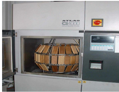
Şekil 4: Yaşlandırma cihazı (Weather-ometer); (Atlas CI 4000).
