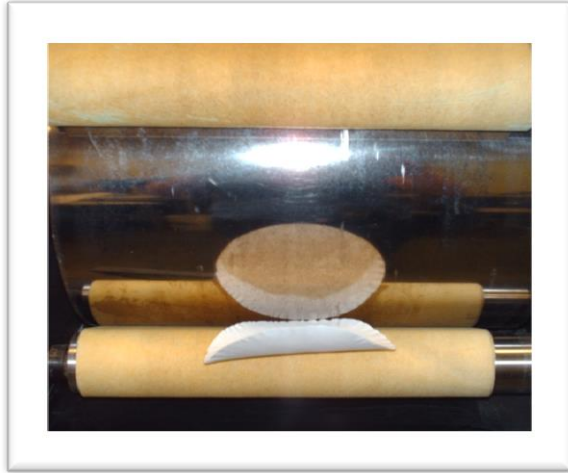
FotoĖraf 21: Sıcak silindirde kâĖitlerin kurutulması ve dzleřtirilmesi
