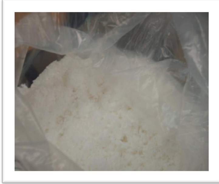
FotoĖraf 11: AĖartma iřleminden geirilmiş yumuřamıř kâĖit( pulp)
