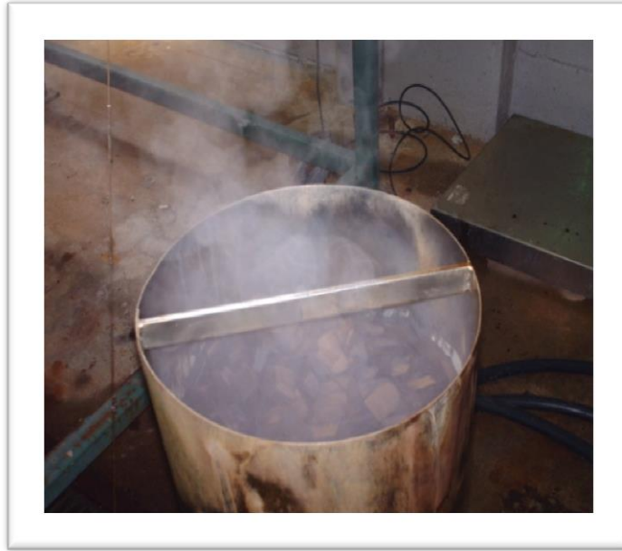
Fotoğraf 10: Makinede su ile pişirilerek linyit maddesi çıkarılmış cipsler
