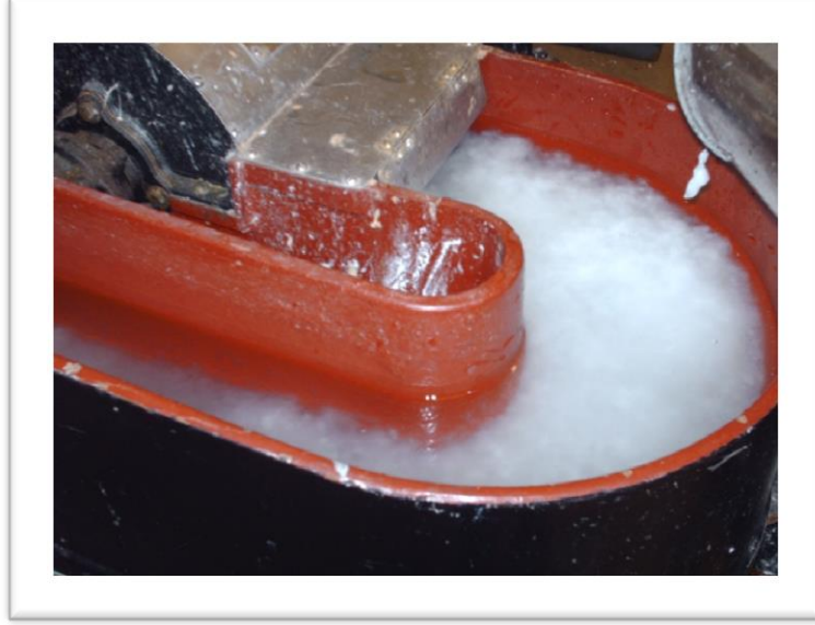
FotoĒraf 15: Hollander makinesinde karıřımın ezilmesi
