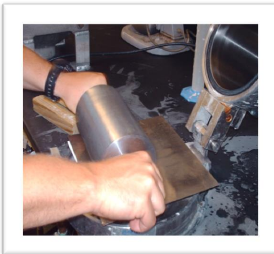
Fotoğraf 19: Metal levha üzerine madeni merdane ile kâğıdın düzleştirilmesi
