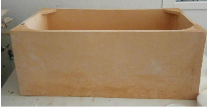
Şekil 3. : Yapımı Tamamlanan Sagar Kutusu
