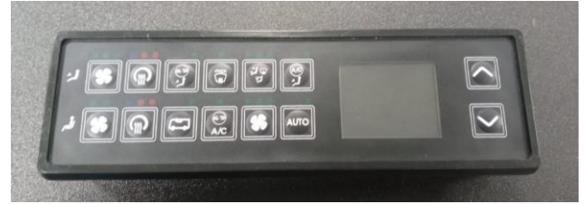
Şekil 2. HVAC Kumanda Paneli
