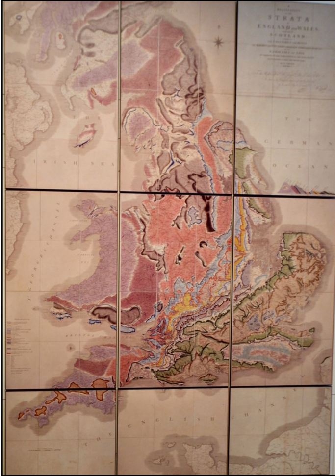
Resim 2. William Smith tarafından her yıl binlerce kilometre yol gidilerek oluşturulmuştur. Smith kayalıkların zemin ya da tabakaların dizilişleri ile olan bağlantısını ortaya koymuştur ve bunlar içerisinde bulunana fosil türlerinden yola çıkarak farklı tabakaları tanımlamıştır. Bu bilgileri kullanarak ülke boyunca farklı tabakaları ifade eden renklendirmeyle haritalandırmayı yapmıştır. Haritanın bir örneği Londra Doğa Tarihi Müzesi'nde sergilenmektedir. Fotoğraf: Damla Ülker, kişisel arşivi.
