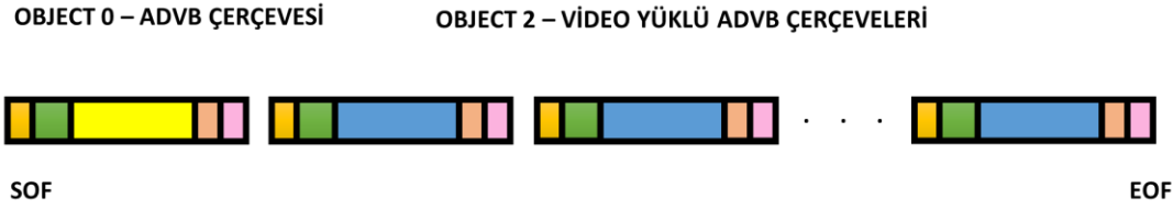
Şekil 3. Tek geçişli video formatındaki konteyner yapısı
