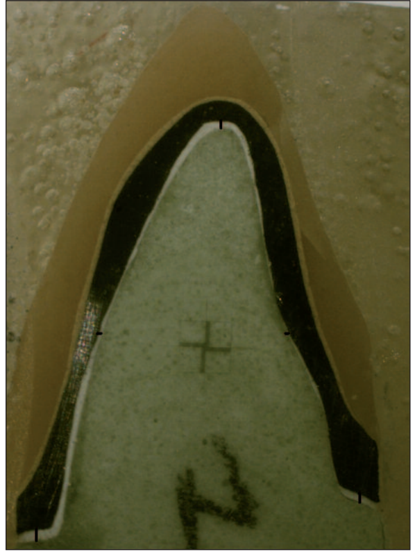
Şekil 1. Kesit yüzeyi üzerinde ölçüm yapılan 5 nokta (x13)
