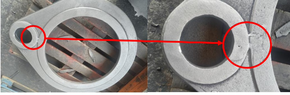
Şekil 5. Simülasyonda Çekinti Tespit Edilen Ürünlerin Gerçek Döküm Hataları
