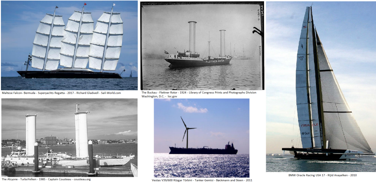
Şekil 1.1. Sağ üstten sola doğru rüzgâr sevk sistemleri: dynarig, flettner rotor, rijit yelken, turbo-yelken, dikey rüzgâr türbini (sail-world.com, loc.gov, wikipedia.org, cousteau.org, Bockmann & Steen).
