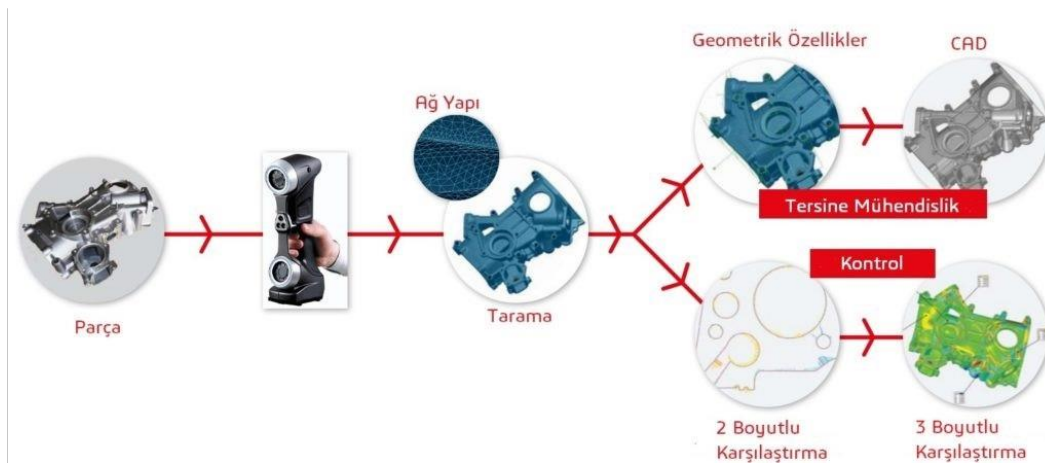
Şekil 1. Tarama işlemi ile kalite kontrol ve tersine mühendislik süreçleri [11]
