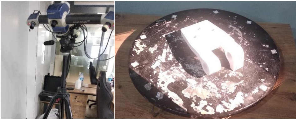
Şekil 6. Breuckmann Smartscan 3D HE beyaz ışık teknoloji 3B tarama işlemi
