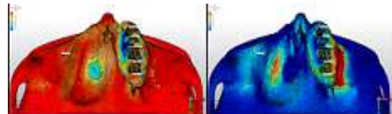
a)Min. principle stres b) Max principle stres Şekil 7. 1. Model 1. yüklemeyeindeki stres bulguları
