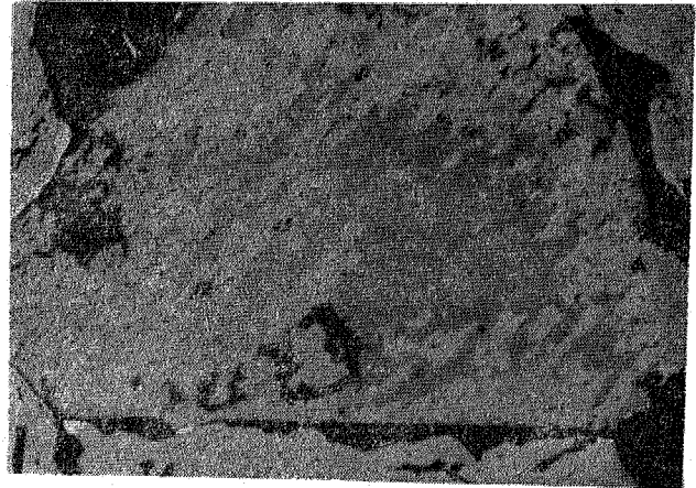
Mikrofoto 4 : Büyütme 160 X, Gliserin yağında ; Kısmen rutil + hematite dönüşen ilmenit manyetit (ilmenitten daha »çık gri) itişmen martitleşme gösteriyor. Gang ve boşluklar siyah renkli,
