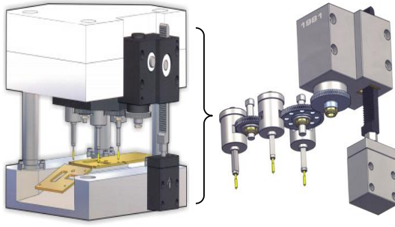
Şekil 7. Kremayer dişli sistemi ile mekanik kılavuz çekme yöntemi (Mechanical tapping method and rack system)
