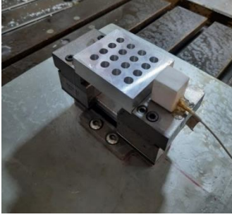
Şekil 7. HSSE-Co5 (TiAlN kaplamalı) matkap ile delik delinen numune
